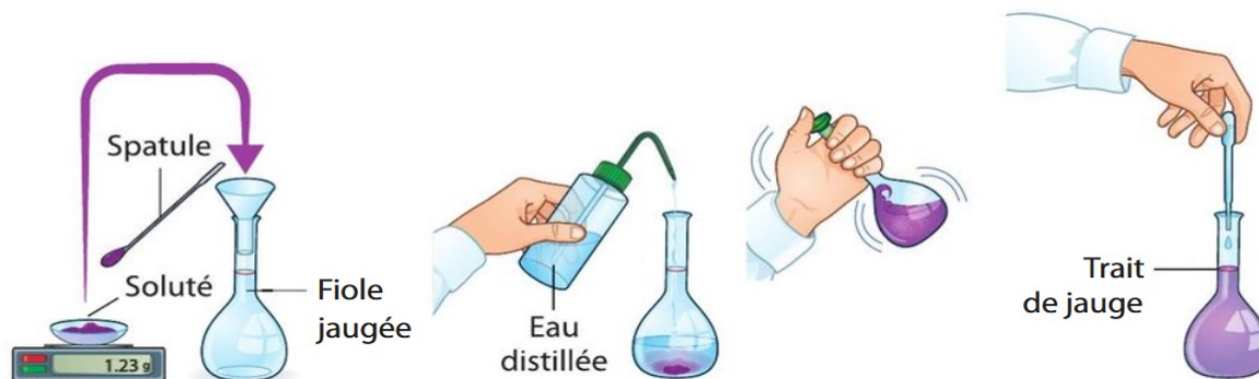
Document 3 : Les étapes en image de la préparation de solution par dissolution au laboratoire
