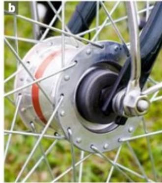
1 Un alternateur bouteille **a** et un alternateur moyeu **b**.
